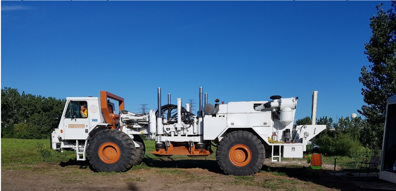
Figuur 6: Big Shaker ("T rex") op locatie. De 'shaker' is de oranje schijf midden onder deze dinosaurus.
