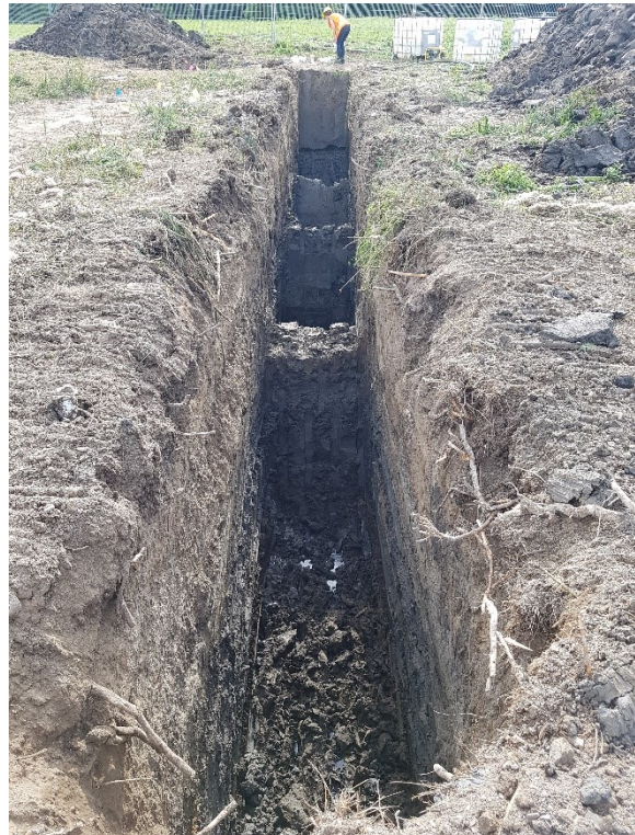
Figuur 4: Sleuf in wel behandelde bodem, geen teken van bezwijken
