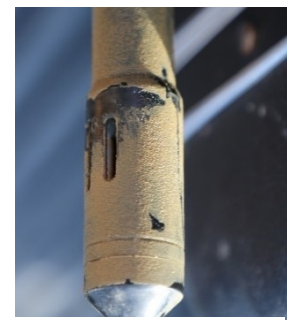
Figuur 2: Calciet gecoate sensor
