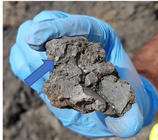
Figuur 3: Calciëet kristallen (wit materiaal) in behandelde bodem
